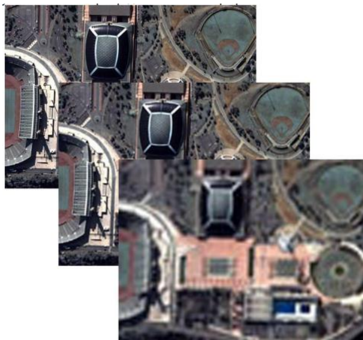
4-сурет. Әр түрлі кеңістіктік ажыратымдылықтағы аэрофотосуреттердің мысалдары: 0,6 м (жоғары), 2 және 6 м (төменгі))
