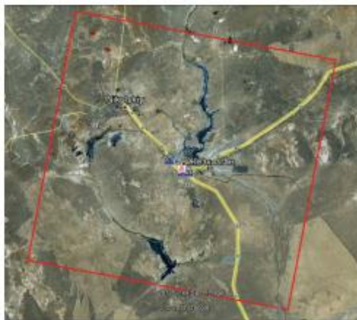
14-сурет. Жезқазған аумағын жабу схемасы түсіру режимінде RADARSAT-2 деректерімен кен орындары Fine (қызыл контур). Кадр ауданы-50x50 км, кеңістіктік рұқсат-7 м, радар толқынының ұзындығы- 5,5 см
